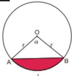
Površina kružnog odsečka se dobija kad od površine kružnog isečka oduzmemos površinu trougla ABO.
